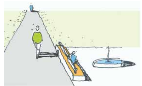
Baksiden av en benk kan inngå som et element i den sammenhengende naturlige ledelinjen.
