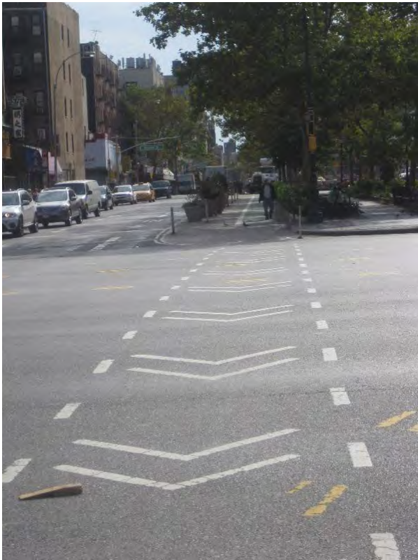
Figur 2.13: Oppmerking av sykkelfelt gjennom kryss, med piler som angir retning
