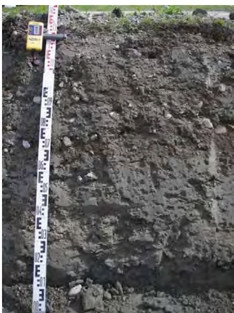
Figur 53. Ved utbygging av Risvollan brl. ble det naturlig jordprofilet ødelagt pga. masseforflyttinger. Jorda ved regnbedet bestod av leire med partier av sand og grus. Vi ønsker å ha full kontroll over vannet som strømmer til regnbedet. For å hindre grunnvanntilsgig til filteret, ble en 1,5 mm PP plastmembran lagt over hele det utgravde regnbedområdet (se figur. 42).
