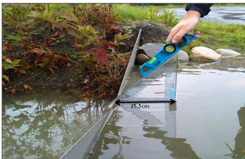
Trekantvinkel og vater kan brukes til avlesning av vannhøyden i V-overløp (foto: T. Dalen).
