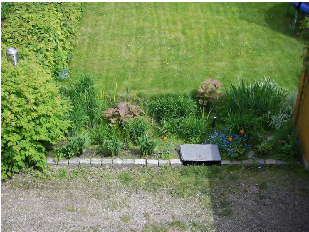
Figur 18. Oversiktsbilde over L34b med Lambrecht kortidsnedbørmåler, V-overløp inn (under skiferhelle) og V-overløp ut (skjult bak vegetasjon ved garasjen). 2. juni 2011.
