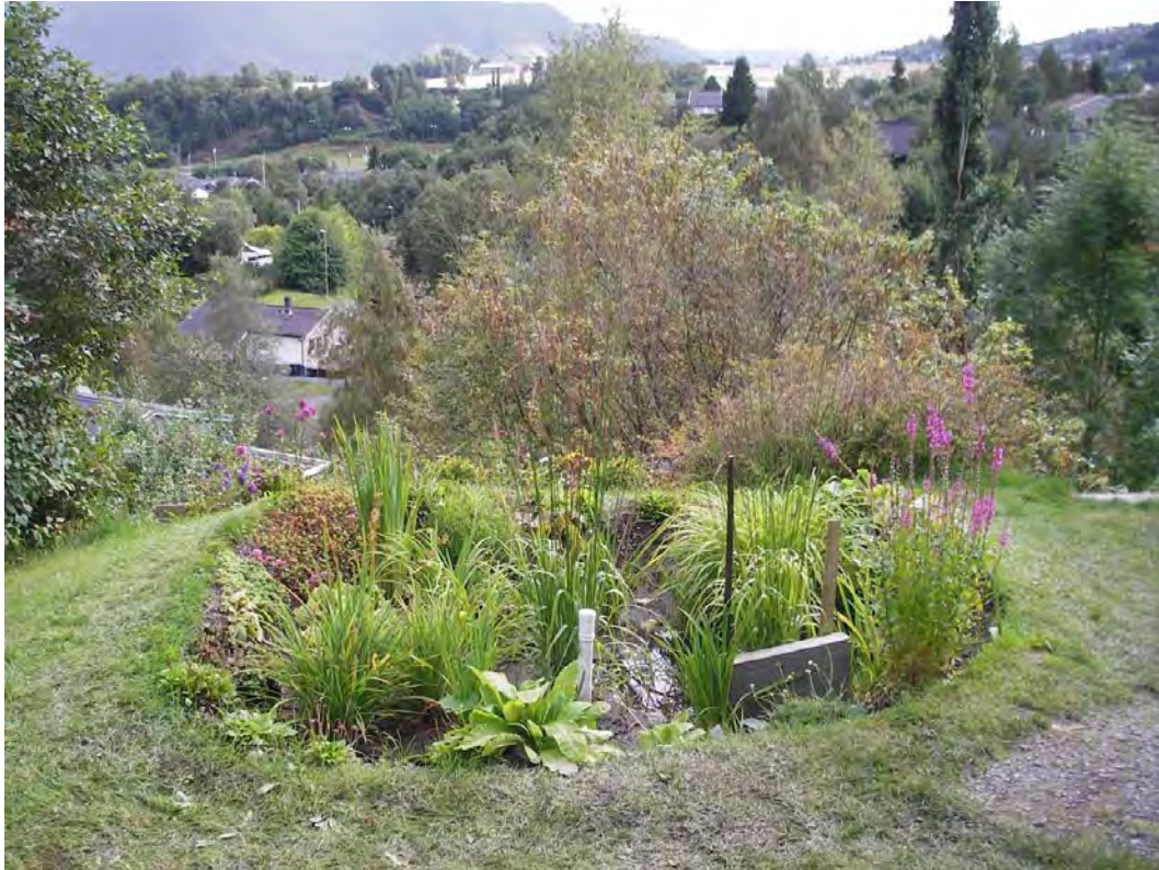
Figur 38. H8 september 2011. Trykksensor er montert i det hvite markvannsrøret. Legg merke til steinplata som reduserer vannhastigheten inn i regnbedet.
