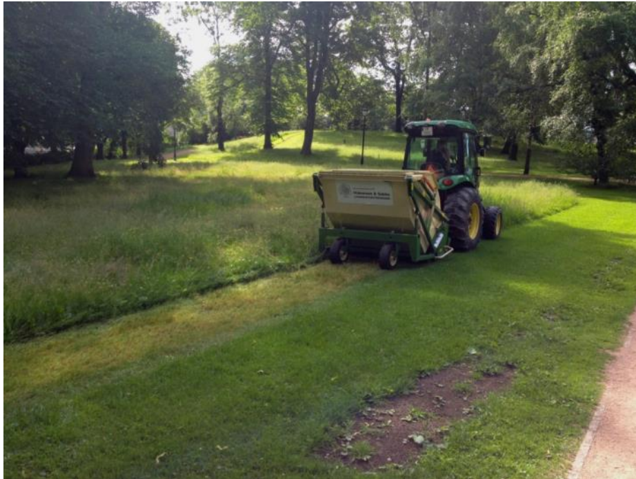
Høytippende vertikalskjærer ble brukt til slått i 2012 og 2013. Avklippet ble mellomlagret før bortkjøring til deponi. Foto: Tor Smaaland.
