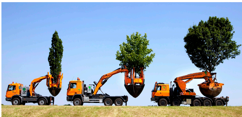
Trädspadar med grävaggregat i olika storlek. Foto: Opitz International.
